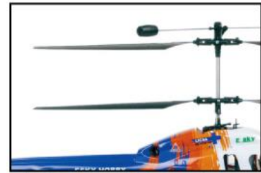
Main blades rotate in same plane 主旋翼旋转在同一平面
