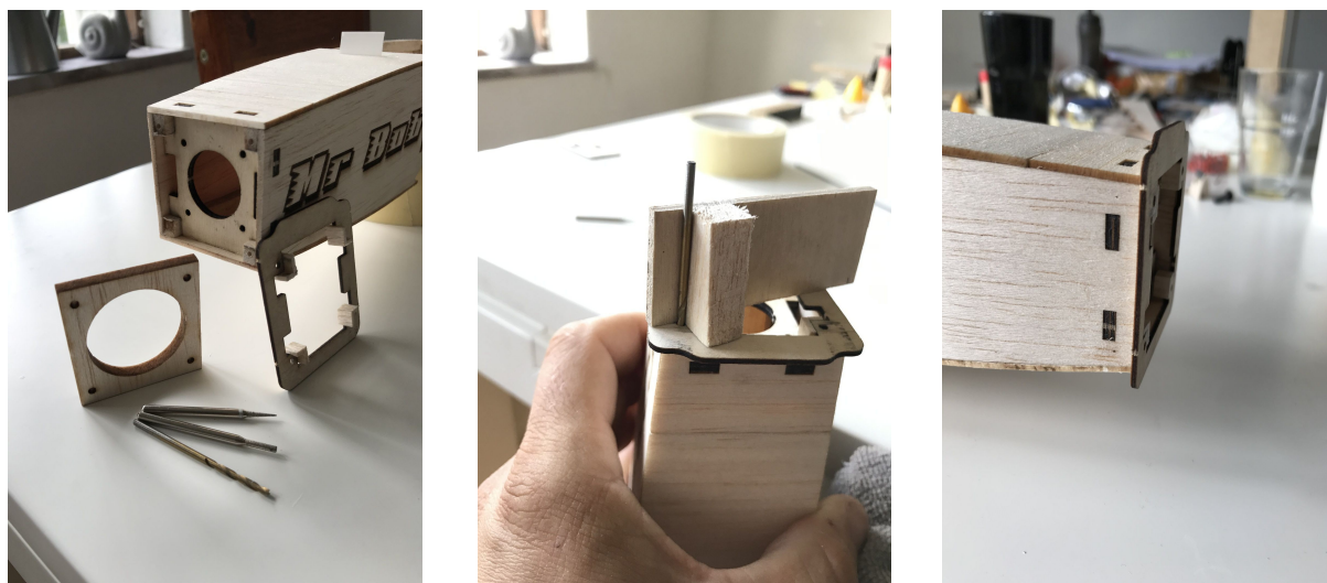
Mall med styrvinklar, borrhning i rät vinkel genom mallen, redo att borra 4 hål in i hörnlisterna.
