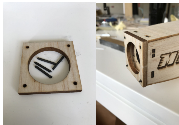
Mall med styrvinklar, borrhning i rät vinkel genom mallen, redo att borra 4 hål in i hörnlisterna.
