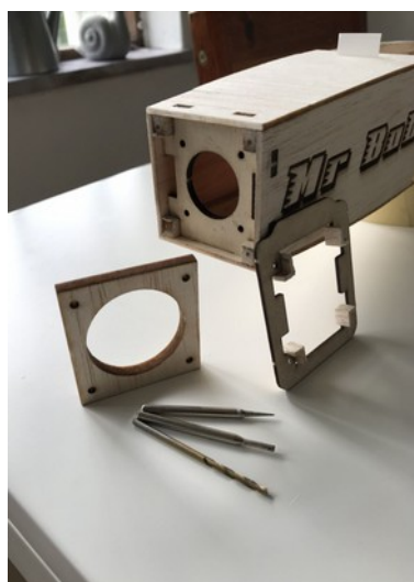
Mall med styrvinklar; borring i rät vinkel genom mallen, redo att borra 4 hål in i hörnlisterna.
