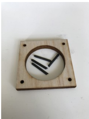
Mall med styrvinklar; borring i rät vinkel genom mallen, redo att borra 4 hål in i hörnlisterna.
