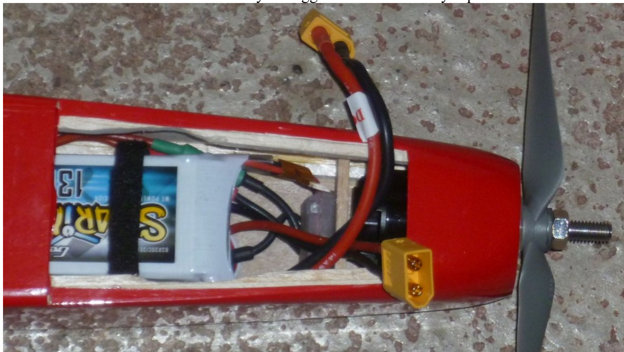
Här en baktung 1060 med 110g batteri långt fram. Uttag i hörnlisterna(9) för batteriets kablar.
