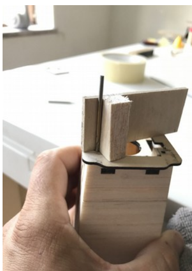
Mall med styrvinklar; borring i rät vinkel genom mallen, redo att borra 4 hål in i hörnlisterna.
