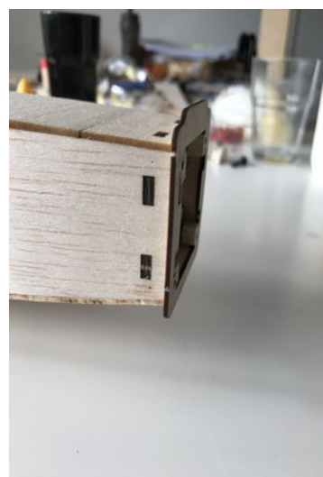
Mall med styrvinklar; borring i rät vinkel genom mallen, redo att borra 4 hål in i hörnlisterna.
