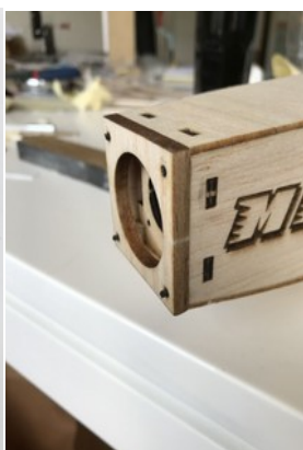
Mall med styrvinklar; borring i rät vinkel genom mallen, redo att borra 4 hål in i hörnlisterna.
